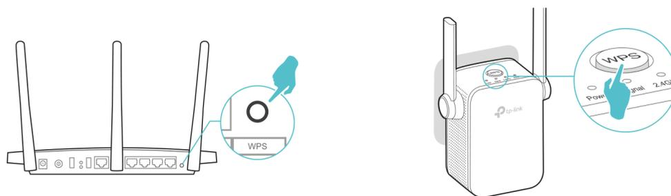
Se si effettua la connessione dell'extender ad un modem/router dual band, ma solamente uno dei LED 2.4GHz o 5GHz LED si accende, ripetere i passi 1 e 2 per connettere l'altra banda.
